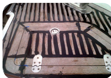
Calafataggio prima della carteggiatura con (foto sopra) e senza spatolatura (a sinistra)
