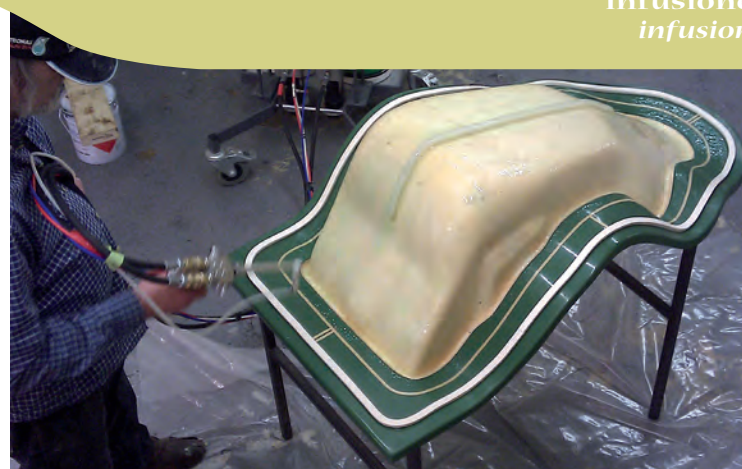
Fig. 7 Realizzazione della membrana con applicazione a spruzzo Silicone bag production by spray application
