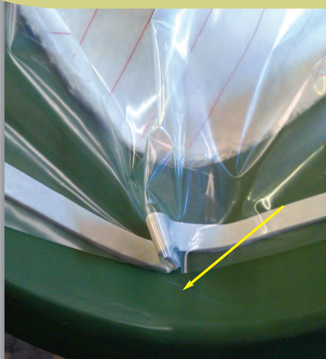
Fig. 2 Piegatura nel sacco del vuoto a bordo flangia Pleat in bag at flange edge
