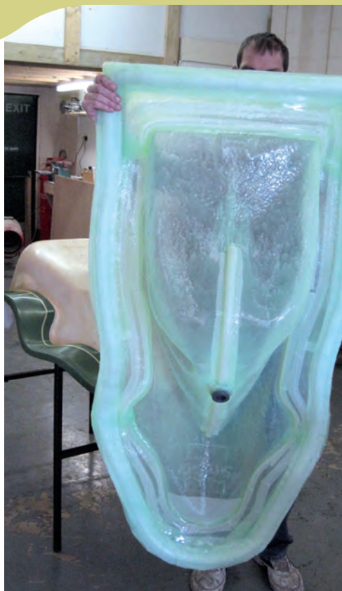
Fig. 3 Membrana riutilizzabile in silicone con geometria che riproduce lo stampo Moulded net shape reusable silicone bag
