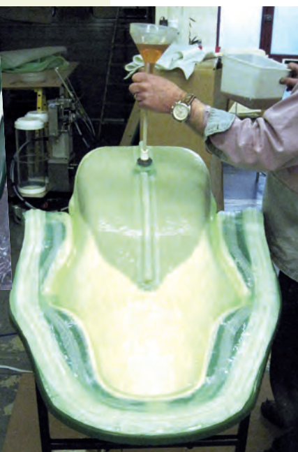
Fig. 8 Infusione sotto vuoto. La resina entra dal punto centrale e scorre longitudinalmente attraverso i canali. La quantità di resina è determinata in via preliminare per assicurare un corretto volume associato allo stampo e il rapporto con le fibre Basic infusion under vacuum. Resin enters a central insert point and flows longitudinally through the key hole resin runner. Resin quantity is predetermined to ensure correct volume for the mould size and fibre volume fraction
