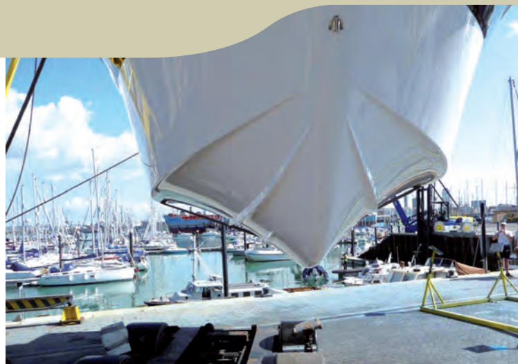
Fig. 5 Daedalus 30 è stato costruito interamente con i prodotti Scott Bader basati sul sistema combinato Crystic per uso nautico, che comprende il gelcoat LS31PA iso/npg, il rivestimento barriera Crestacoat 5000PA e lo skincoat VE679PA vinilestere/DCPD Daedalus 30 was constructed entirely from Scott Bader products using their recommended Crystic® matched marine system, which included LS31PA iso/npg gelcoat, Crestacoat 5000PA barriercoat and VE679PA vinyl ester/DCPD skincoat
