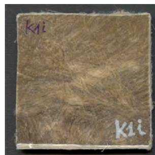
Fig. 2 - Provino da impatto, mat di canapa al 44%
