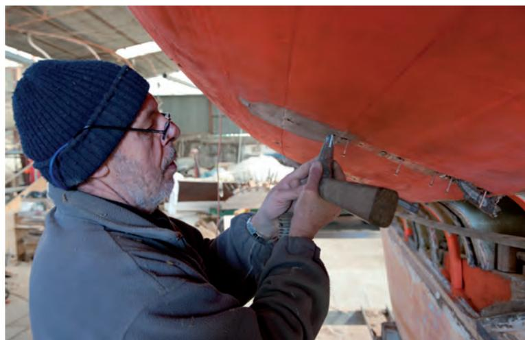
Sandro Pezzini effettua la chiodatura del fasciame sulle ordinate eseguita in modo tradizionale con chiodi di rame quadri da 3,5 mm. ribattuti dall'interno dello scafo ed il calafataggio del fasciame con cotonina (nella foto alla pagina seguente). Sandro Pezzini is riveting the planking on frame following the traditional method based on 3,5 mm square copper rivets, hammered inside the hull with planking caulking with calico (next page).
