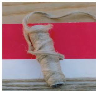
Fig. 1 - Bobina di fibra di canapa
