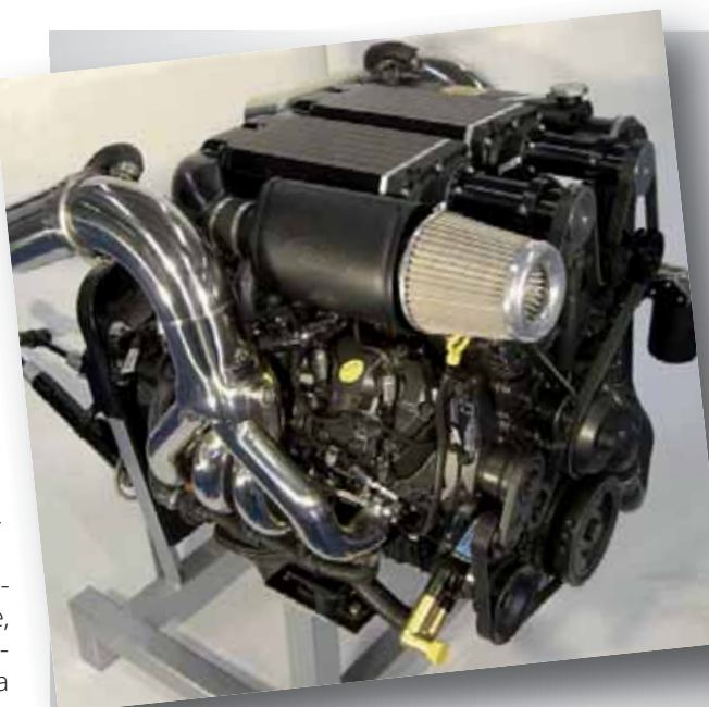
Motore MarineDiesel TSC-505Hp a doppio compressore volumetrico
