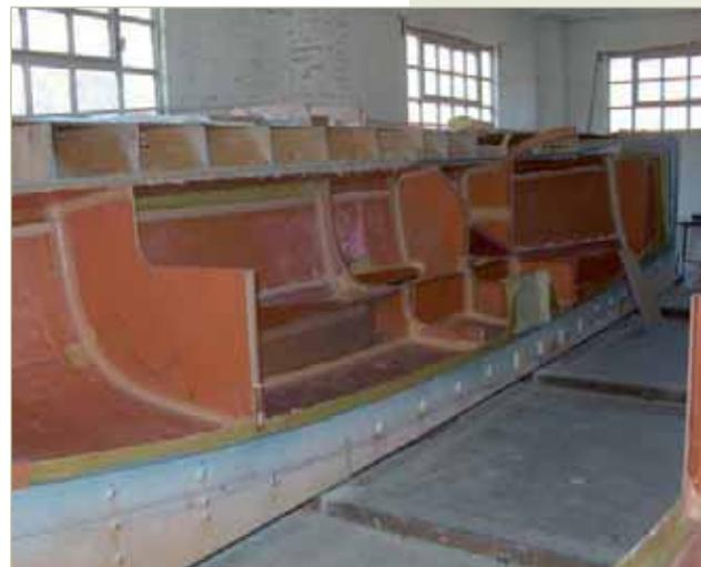
Mezzo scafo con tutte le strutture montate. Il semi stampo sinistro scorre su due binari per incollarsi alla metà destra. Si può vedere la flangia lungo la chiglia e le flangie delle strutture.
