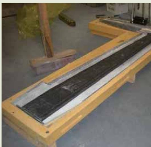
Costruzione della nuova deriva da stampo femmina. Viene prima realizzata una laminazione di tutta la superficie ala e bulbo. Successivamente vengono posizionati nello stampo la fusione in piombo e l'asse di carbonio realizzato separatamente. Nella fase finale i due semistampi vengono incollati tra di loro senza nessuna fascettatura
