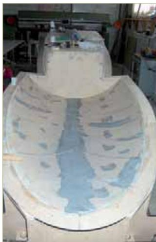
Stampo di tuga e pozzetto in preparazione. Lungo tutto il perimetro è stata predisposta la superficie per la flangia di incollaggio alla coperta
