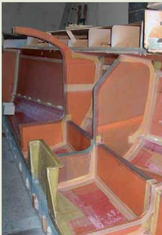
Il mezzo scafo destro. Flangie predisposte per l'incollaggio compresa la scassa di alloggiamento della deriva
