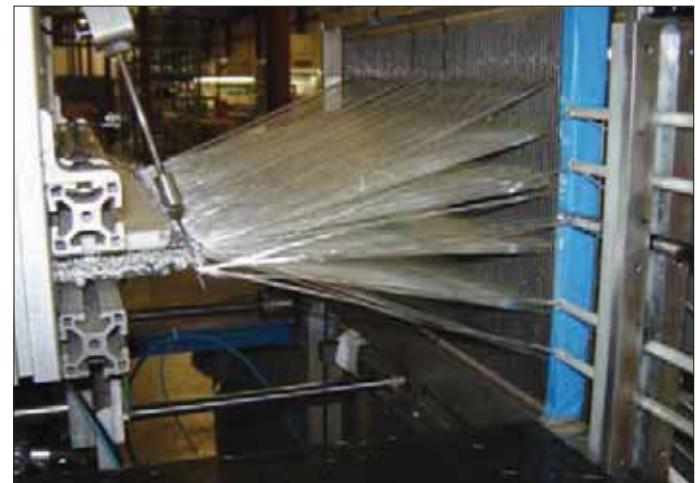
Fig. 10 - Inserzione simultanea di 5 filati sulla macchina tessile per tessitura ortogonale 3D di Tex. La rastrelliera superiore inserisce i filati di acciaio inossidabile e gli altri 4 stoppini E-glass
