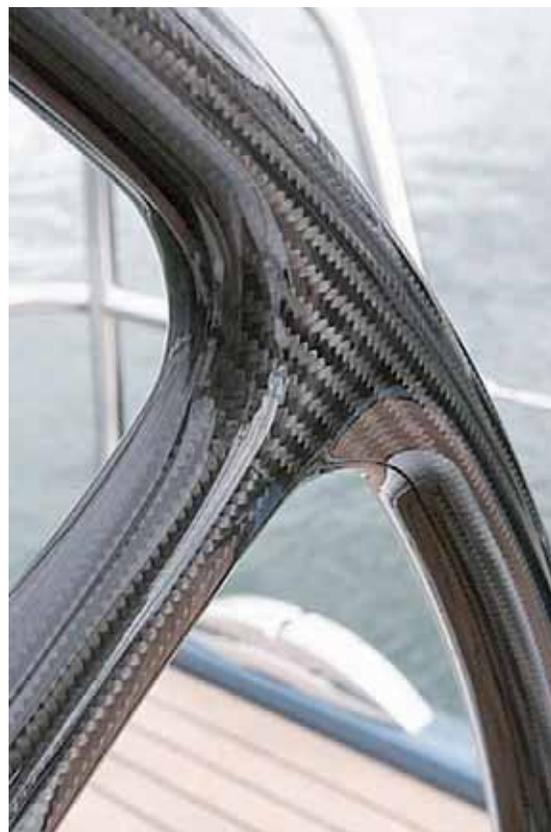
220 cm passerella fissa, 216 cm passerella pieghevole, 285 cm passerella pieghevole, 350 cm passerella pieghevole. Le ruote per timoneria sono realizzate con una tecnologia sviluppata e brevettata dall'azienda (Brevetto n.1.350.611) in una singola monoscocca cava di carbonio, senza linee d'incollaggio o punti deboli, e risultano estremamente leggere e robuste e di facile utilizzo. Le ruote per timoneria sono tutte marcate CE.
